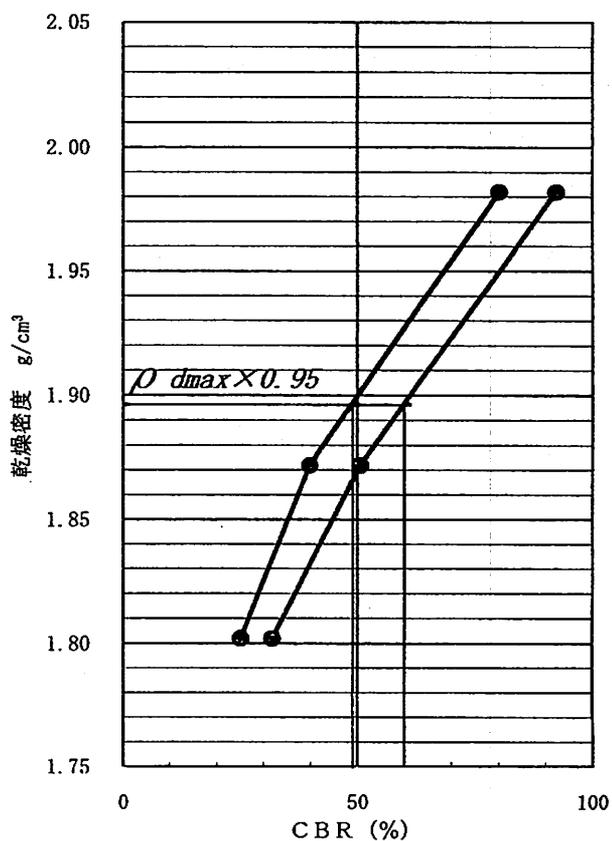
路床土支持力比 (CBR試験) [室内試験] X-Y ELECTRONIC RECORDER CHART
